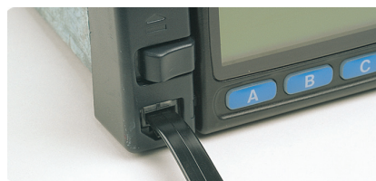
I fästplattans nedre vänstra hörn finns en kontakt för anslutning av monofon. Kontakten används också för anslutning av en PC då man vill programmera om sin station utan att avlägsna den från bilen.
