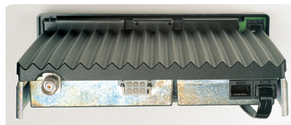
Radiodelen, kan placeras skild från manöverpanelen, t ex under ett bilsäte. Dessutom kan flera manöverenheter anslutas till en radio. Anslutningskontakterna utgörs av standardiserade modularkontakter för enklast möjliga installation.
