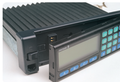
Manöverpanelen, som innehåller användarens "personliga" parametrar, kan knäppas loss och flyttas över till ett annat fordon.
